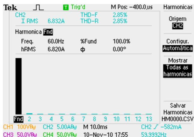
Figura 119: Resultado experimental com o sistema de controle proposto: Espectro harmônico e THD da corrente de entrada com carga nominal resistiva.
