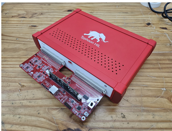
Figura 139 – Emulador de tempo real Typhoon HIL402.
