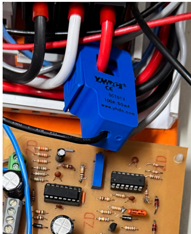
Figura 64 – Sensor de corrente SCT-013.
