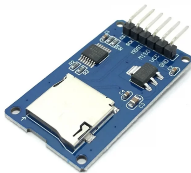
Figura 45 – Módulo de gravação em cartão de memória.
