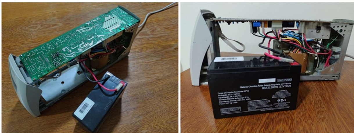
Figura 108 - UPS comercial com a bateria conectada externamente para realização dos ensaios
