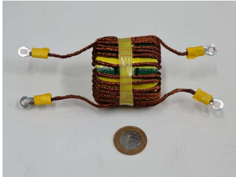
Figura 60 – Autotransformador ( AT ) confeccionado para o protótipo do inversor.
