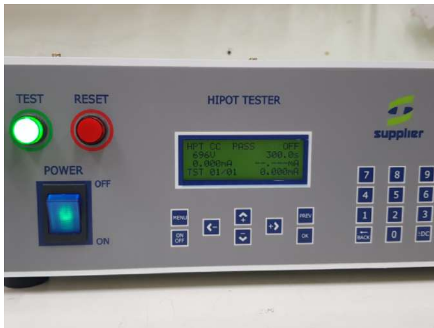
Figura 70 – Modelo do aparelho HIPOT utilizado para ensaios.
