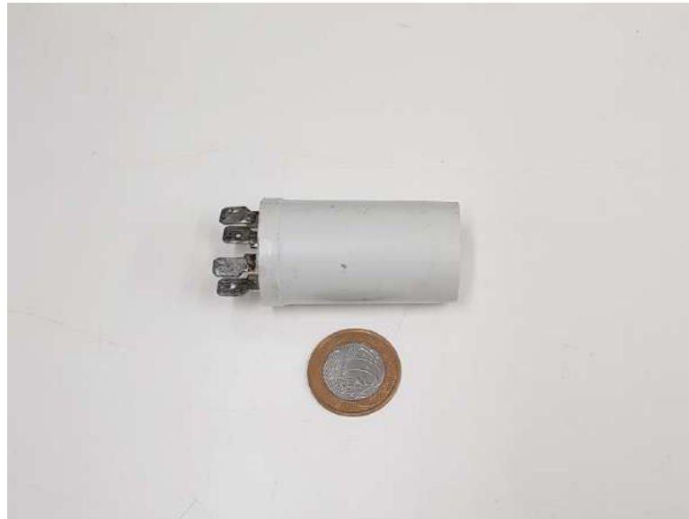
Figura 64 – Capacitor ( C_o ) utilizado como filtro de tensão protótipo do inversor.
