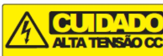
Figura 3 – Placa de aviso de alta tensão contínua presente.
