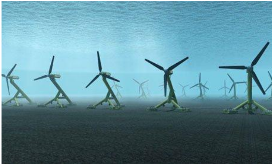
Figura 9 – Estrutura Maremotriz do Tipo Parque de Turbinas
