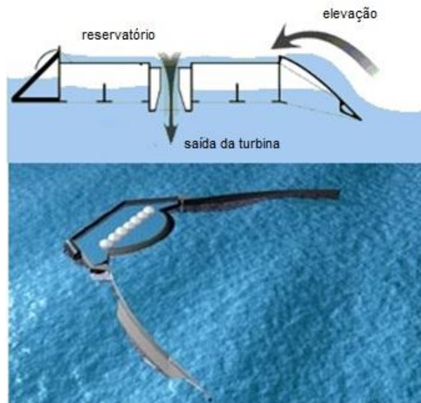
Figura 16 – Estrutura de usina de elevação
