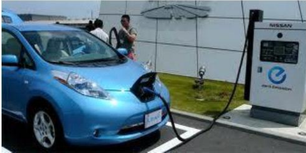
Figura 6 – Modo 3 de carregamento
