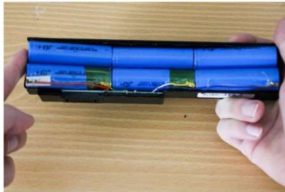
Figura 27 - Bateria de notebook da marca Asus com o encapsulamento aberto, demonstrando a presença de 6 células de Lítio, de forma 3S2P
