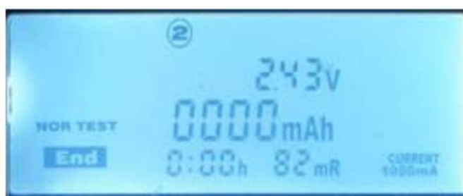
Figura 32 - Informativo do equipamento Lii-500, relatando o fim do NOR TEST com Capacidade igual a 0 mAh
