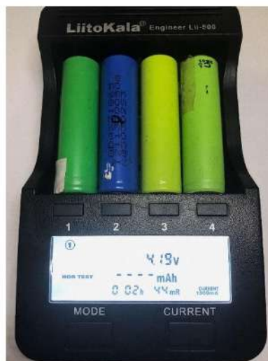
Figura 28 - Carregador e analisador LiitoKala Lii- 500, conectado com 4 células de Lítio-Íon
