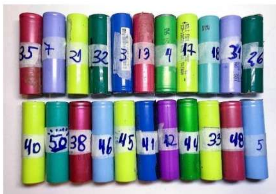
Figura 31 - Células de Lítio-Ion recicladas, após serem testadas e classificadas
