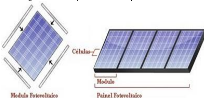
Figura 3.8 - Componentes de um painel fotovoltaico.
