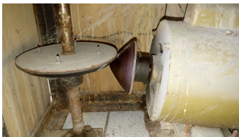
Figura 2 – Torno de oleiro utilizando sistema de coroa e pinhão de transmissão.
