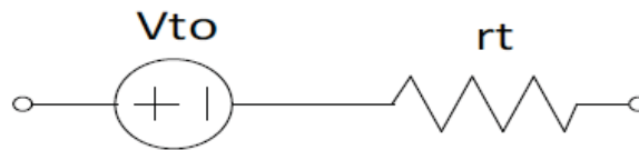
Figura 4.5 – Modelo equivalente de perdas de um diodo
