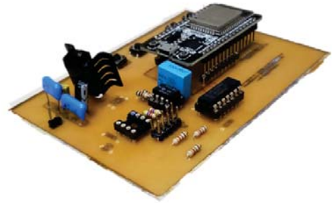
(b) Placa de condicionamento construída.
