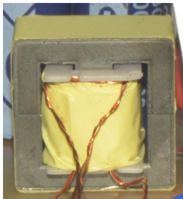
Figura 42 – Transformador do projeto convencional.
