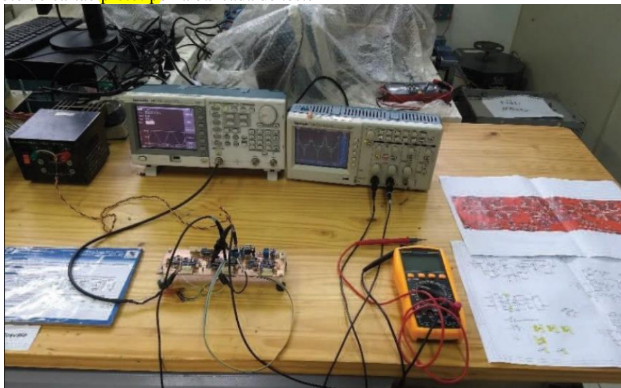
Figura 68 – Foto do cartão protótipo na bancada de teste
