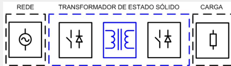
Figura 1. – Estrutura de um transformador de estado sólido.
